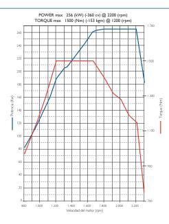
Potencia del motor: 265 kW (360 CV) @ 2 200 rpm Par máximo: 163 Kgm (1500 Nm) @ 1200 - 1650 rpm
